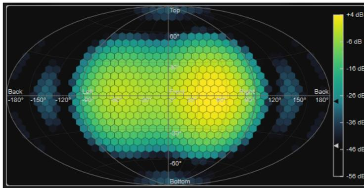
Una representación plana del campo sonoro esférico Ambisonics muestra una rejilla de hexágonos. El color de un hexágono indica el nivel de RMS en esta posición. El filtro le permite suavizar la visualización.
