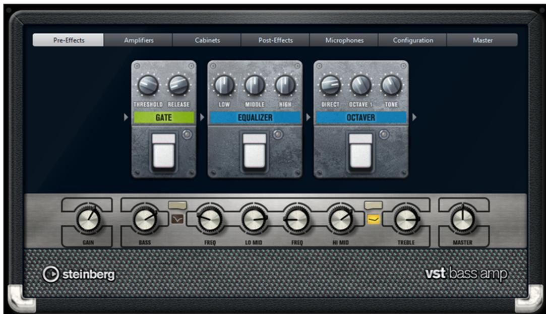
En la parte superior del panel del plug-in, los siguientes botones abren diferentes páginas en la sección de visualización del panel de plug-in: **Pre-Effects, Amplifiers, Cabinets, Post-Effects, Microphones, Configuration** y **Master**.
