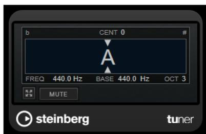
Il display grafico indica l'altezza attualmente suonata sotto forma di una nota. Le due frecce indicano qualsiasi deviazione dell'altezza. La deviazione viene visualizzata anche nell'area superiore del display. Se la nota suonata è il bemolle dell'altezza, l'indicatore dell'altezza si trova sulla sinistra. Se la nota suonata è il diesis, l'indicatore si trova sulla destra.
