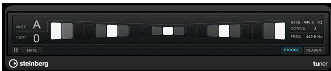
In modalità **Classic**, un indicatore visualizza qualsiasi deviazione dell'altezza. Se la nota suonata è un bemolle, l'indicatore si trova a sinistra rispetto alla metà del display. Se la nota suonata è un diesis, l'indicatore si trova a destra. Se si suona l'altezza corretta, l'indicatore si trova esattamente a metà e diventa di colore grigio.
