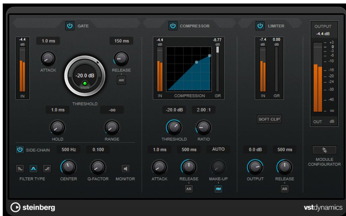
La finestra del plug-in è divisa in tre sezioni, ciascuna contenente controlli e indicatori dedicati per ciascun effetto. Per attivare i singoli effetti, utilizzare i pulsanti **Gate**, **Compressor** e **Limiter**. È possibile scegliere tra tre diverse opzioni di assegnazione utilizzando il pulsante **Module Configurator**.
