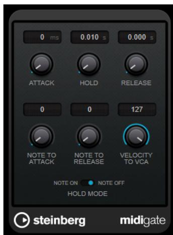
Gli effetti di gate consentono sostanzialmente di silenziare i segnali audio che si trovano al di sotto di un determinato livello di soglia. Se un segnale supera il livello impostato, il gate si apre in modo da lasciarlo passare. I segnali al di sotto di questo livello vengono silenziati. Il plug-in **MidiGate** non viene però attivato da dei livelli soglia, ma dalle note MIDI. Di conseguenza, questo plug-in necessita sia di dati audio che di dati MIDI per operare.
