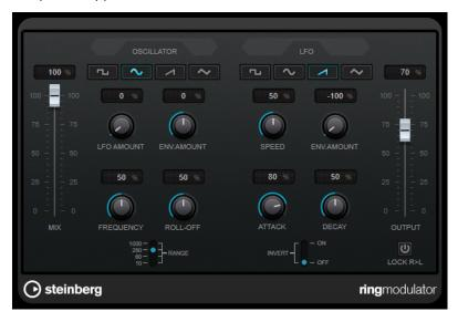
La modulation en anneau consiste à multiplier deux signaux audio. La sortie modulée en anneau contient des fréquences supplémentaires générées par la somme et la différence des fréquences des deux signaux.
