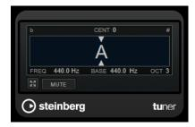
La hauteur actuellement jouée est représentée par une note sur l'affichage graphique. Les deux flèches indiquent l'écart de hauteur. L'écart est également indiqué en haut de l'affichage. Quand la hauteur jouée est plus basse que la note, l'indicateur de hauteur se trouve à gauche de la note. Quand la hauteur jouée est plus haute que la note, l'indicateur de hauteur se trouve à droite de la note.
