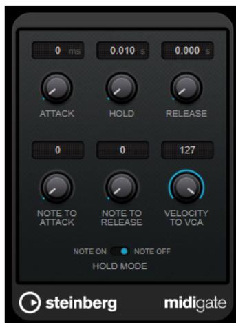
Bei dem so genannten Gating werden Audiosignale stummgeschaltet, die unterhalb eines bestimmten Schwellenwerts liegen. Wenn der Signalpegel den festgelegten Schwellenwert übersteigt, öffnet sich das Gate und das Signal wird durchgelassen. Signalanteile unterhalb der Schwelle werden abgeschnitten. **MidiGate** wird jedoch nicht durch einen Schwellenwert ausgelöst, sondern durch MIDI-Noten, d. h., das PlugIn benötigt eingehende Audio- und MIDI-Daten.
