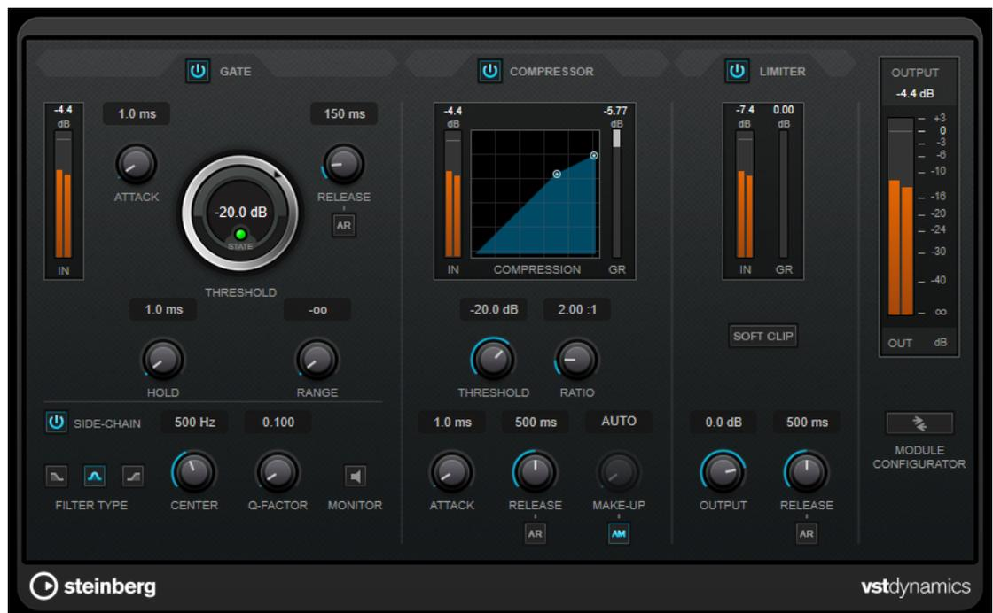
ウィンドウは3つのセクションに分かれており、各エフェクト用のコントロールとメーターが表示されます。「Gate」、「Compressor」、「Limiter」の各ボタンを使用して個々のエフェクトをオンにします。「Module Configurator」ボタンを使用して、3種類のルーティングオプションを選択できます。
