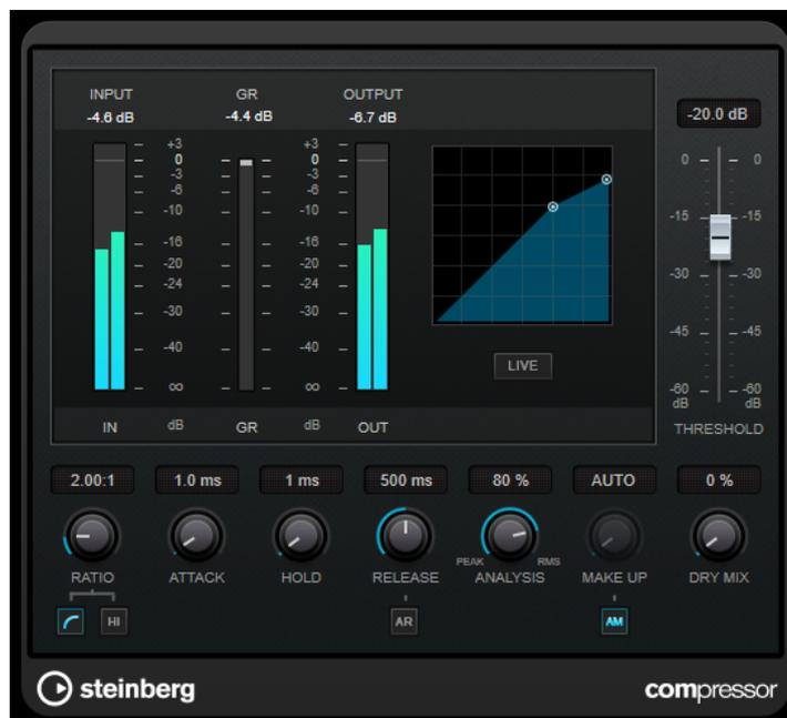
**Compressor** には、「Threshold」および「Ratio」パラメーターの設定に基づいた形のコンプレッサーカーブが個別にグラフィック表示されます。また、「Gain Reduction」メーターにはゲインの dB 単位の減衰量が表示され、ソフトニー/ハードニー圧縮モードと、プログラムに基づいた「Release」パラメーターの「Auto」機能も利用できます。
