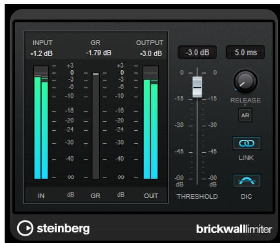
**Brickwall Limiter** では、アタックタイムが早いため、不自然な響きを発生させずに、瞬発的なオーディオレベルピークも低減できます。ただし、1ミリ秒のレイテンシーが発生します。**Brickwall Limiter** には、入力、出力、および制限の量ごとのメーターがあります。このプラグインは、信号チェーンの最後、ディザリングの前に配置します。
