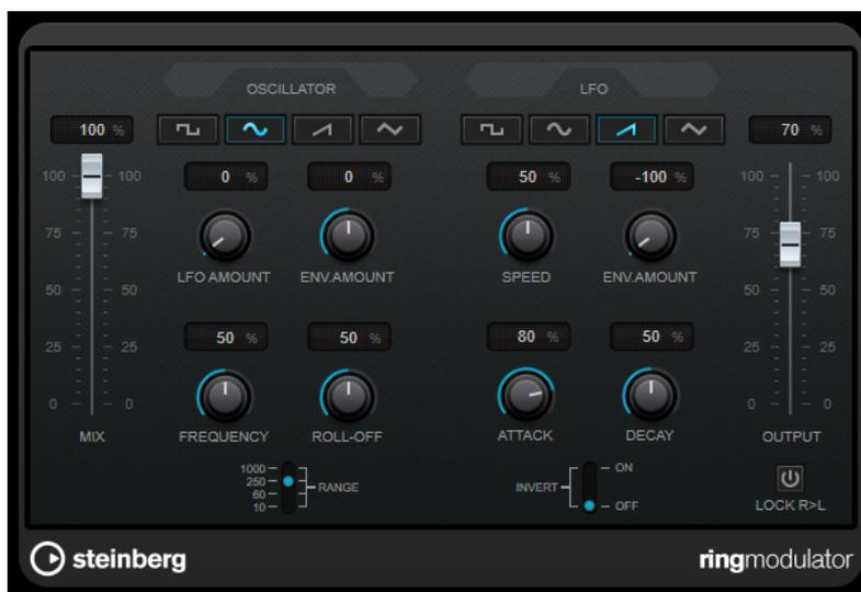
RingModulator は、2つのオーディオ信号を掛け合わせることによって動作します。リングモジュレーターからは2つの信号の周波数の和と差により発生した周波数が追加されて出力されます。
