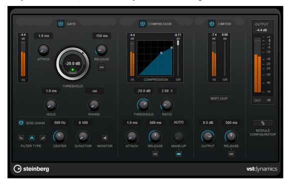
Das Fenster ist in drei Bereiche gegliedert, die Regler und Meter für die Effekte enthalten. Aktivieren Sie die einzelnen Effekte mit den **Gate-**, **Compressor-** und **Limiter-**Schaltern. Mit dem Schalter **Module Configurator** können Sie zwischen drei verschiedenen Routing-Optionen wählen.
