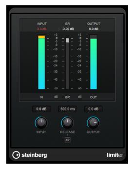
**Limiter** kann den **Release**-Parameter automatisch entsprechend dem Audiomaterial anpassen und optimieren; Sie können den Parameter aber auch manuell einstellen. **Limiter** bietet auch separate Meter für den Eingangs- und Ausgangspegel sowie für den Grad des Limitings (mittleres Meter).
