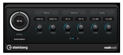
Sie können die Frequenz, Breite und Verstärkung für die **Low**- und **High**-Positionen unabhängig voneinander einstellen. Der Übergangspunkt zwischen diesen Positionen liegt bei 50.
